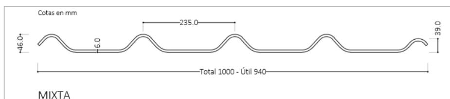
La placa ondulada Perfil Mixto tiene un espesor de 6,0 mm.
