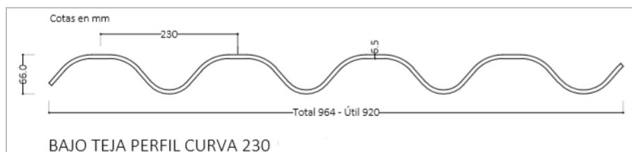
La placa ondulada Perfil 230 C2Y tiene un espesor de 6,5 mm.
