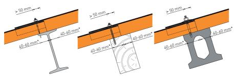
\* 40 mm de apoyo para separación entre correas de 1850 mm. 60 mm de apoyo para separación entre correas de 2350 mm.
