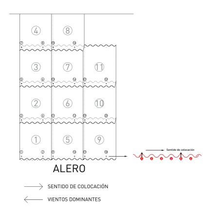
En placas apoyadas sobre 3 vigas (3 apoyos) las fijaciones se colocaran:
