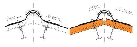
Para la correcta instalación y ajuste posterior de los caballetes las ondas de las placas de ambos faldones deben coincidir en la cumbrera.
