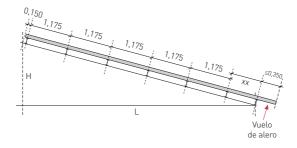
Para el caso de los paneles Agrotherm y Naturtherm se precisa ajustar las unidades de cumbrera para evitar puentes térmicos y/o cortes.
