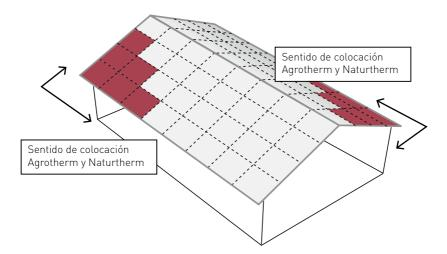
Para el montaje de las placas deben disponerse tablones o pasarelas que permitan la permanencia y el paso de los montadores, de forma que éstos no pisen directamente sobre las placas. Estos tablones deben ser de madera dura de 24 mm de espesor, 250 mm de anchura y 3 m de longitud como máximo.
