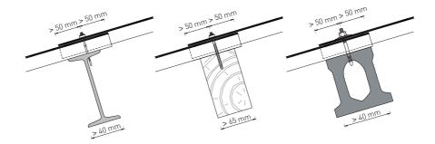
En el caso de paneles aislados, Agrotherm – Naturtherm, se debe garantizar que ambos paneles apoyan sobre la correa cumpliendo el apoyo mínimo exigido para cada panel dependiendo de la distancia entre apoyos y su estanqueidad.
