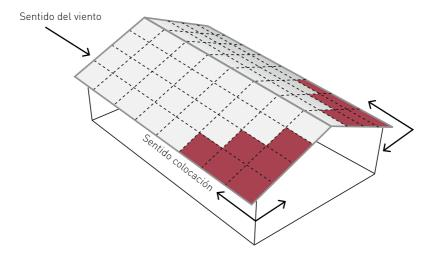
En el caso de los paneles Agrotherm y Naturtherm la instalación será igualmente de abajo hacia arriba, **pero únicamente podrá ser de izquierda a derecha,** debido a la ubicación del solape lateral.
